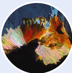
Удлиненные, игольчатые пластинки биотита (зеленовато-розовые) по краям зерен магнетита в образце камня
