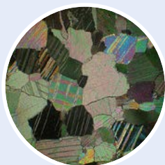
Коелгинский мрамор под микроскопом. Мономинеральная горная порода, состоящая из кальцита [\text{CaCO}_3] .
