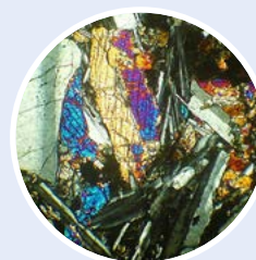
Зерна авгита (цветные пятна) в шлифе базальта Ивано-Долинского месторождения. Фенокристаллы часто имеют двойниковое строение
